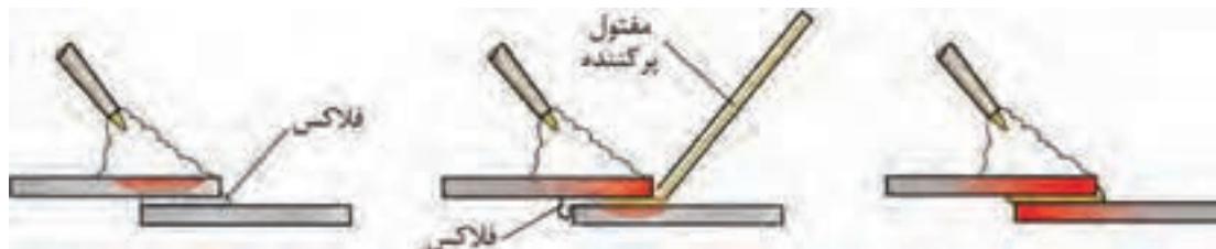
شکل ۲۴- مراحل مختلف جوش با مفتول برنجی
