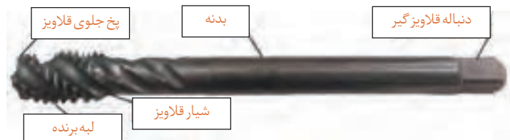
شکل ۲- ساختمان قلاویز ماشینی
