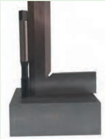
شکل ۷- کنترل عمود بودن قلاویز با سوراخ
