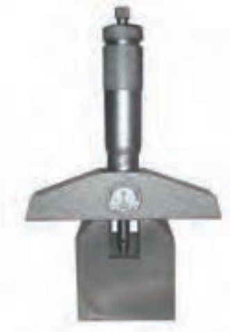
شکل ۵- اندازه‌گیری با میکرومتر عمق سنج
