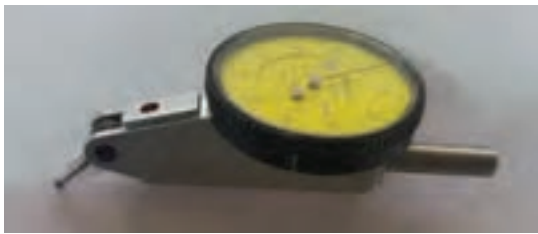
شکل ۲۵- ساعت حساس (شیطانکی) برای کنترل دایره‌ای بودن
