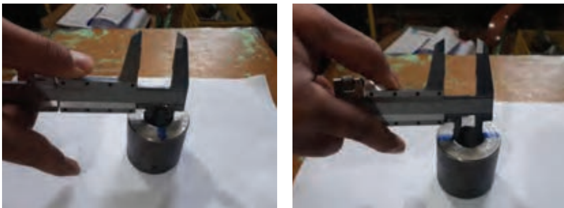
شکل ۲۴- کنترل دایره‌ای بودن سوراخ
