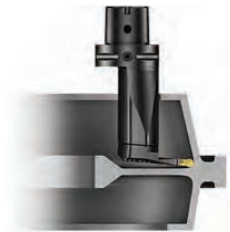
شکل ۶- ایجاد شیار در داخل سوراخ
