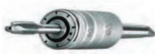
شکل ۵- تجهیزات بستن قلاویز روی ماشین مته ستونی
