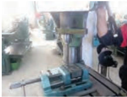
شکل ۱۳- نصب برقوروی محور دستگاه مته
