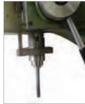
شکل ۱۳- نصب برقوروی محور دستگاه مته
