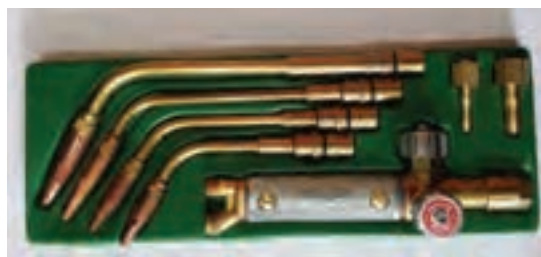
شکل ۲۰- مشعل و سر بک‌های قابل تعویض جوشکاری
